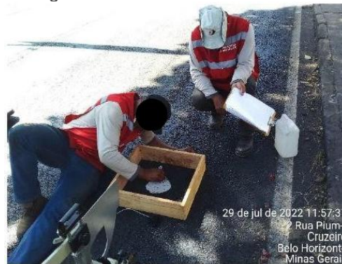
Figura 6. Ensaio Pêndulo Britânico
